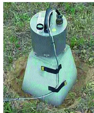
Capteur sismique de type CMG40T utilisé au cours des enregistrements au Mexique.
